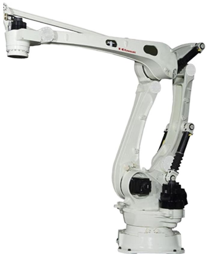
de 500 kg y una velocidad máxima de 900 ciclos por hora. Con un alcance de 3.255 mm, una altura de paletización de 2.200 mm y un peso neto de solo 1.650 kg, el robot CP500L de Kawasaki es el más potente de su clase.
