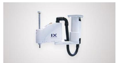
De 4 ejes de montaje a pared y eje invertido
